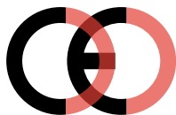
Falsche CE-Kennzeichnung (zu dicht)
